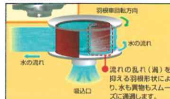
高効率ノンクログ型ポンプの羽根車
